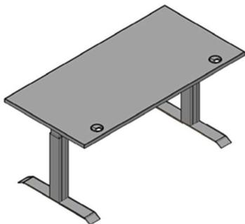
EDV-Tisch **ohne** Rückwand. Stufenlos elektrisch höhenverstellbar von 645 - 1325 mm; Hubweg 680 mm; Hubgewicht max. 120 kg bei gleichmäßiger Belastung der Tischplatte; Höhenverstellung mit Sanftanlauf; Geringer Energieverbrauch (Standby max. 0,3 W); Mit Kollisionserkennung (kein Personenschutz)
